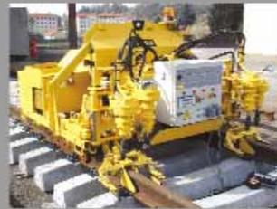
Vierspindelschraubautomat T 2004
